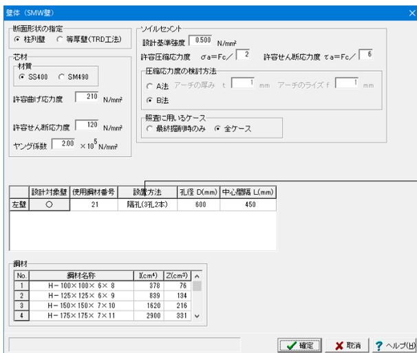
左壁<設置方法:隔孔(3孔2本)>を選択します。
