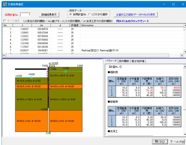
解析が完了すると結果画面が表示されます。結果確認画面では、逆解析結果の確認と、各計算ケースの詳細確認、逆解析の推定パラメータを反映させた「土留め工の設計データ」のエクスポートなどを行います。
