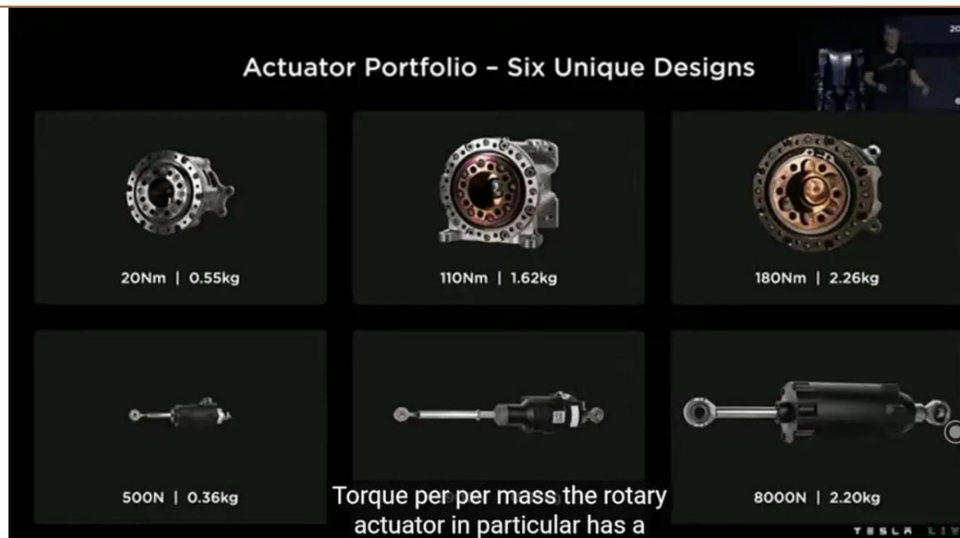
图 32：特斯拉 Optimus 六种不同类型电机执行器
