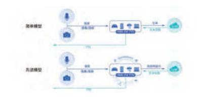
在先进模型中,终端侧AI将能承担更多处理,并提供经过改进的个性化提示。借助终端侧学习终端上的个人数据,通过编排器(orchestrator)程序协作,可创建用户个人画像,基于更多情境信息提供更完善的提示。
