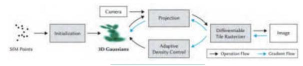
Gaussian Splatting步骤示意图
