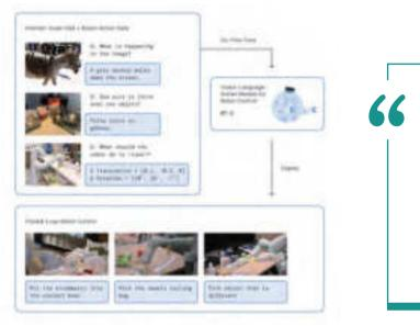
RT-2是一个基于Transformer的模型,根据网络上的文本和图像进行训练,可以直接输出机器人动作。就像语言模型通过网络文本进行训练来学习一般思想和概念一样,RT-2也可以从网络数据中传输知识来告知机器人行为。
