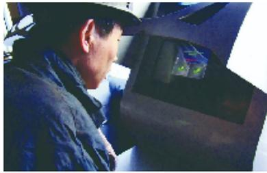
图4 基于虹膜识别的煤矿工人考勤设备
